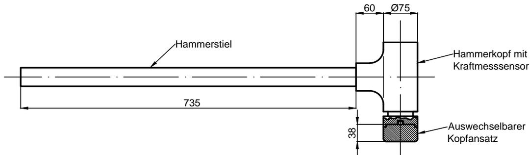
Abbildung 4.15.: CAD-Modell des Hammers
