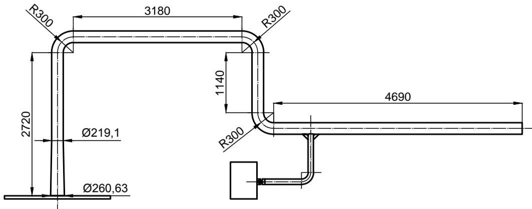
Abbildung 4.10.: Maße des gesamten Versuchsaufbaus
