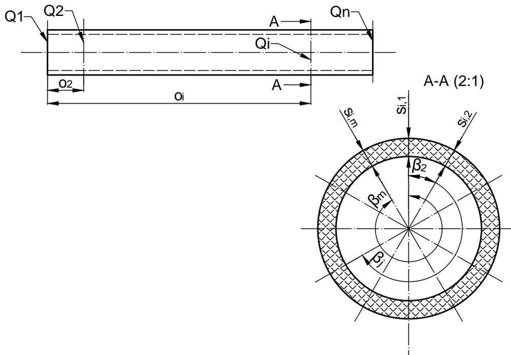
Abbildung 3.10.: Profilmäße der linearen Rohre
