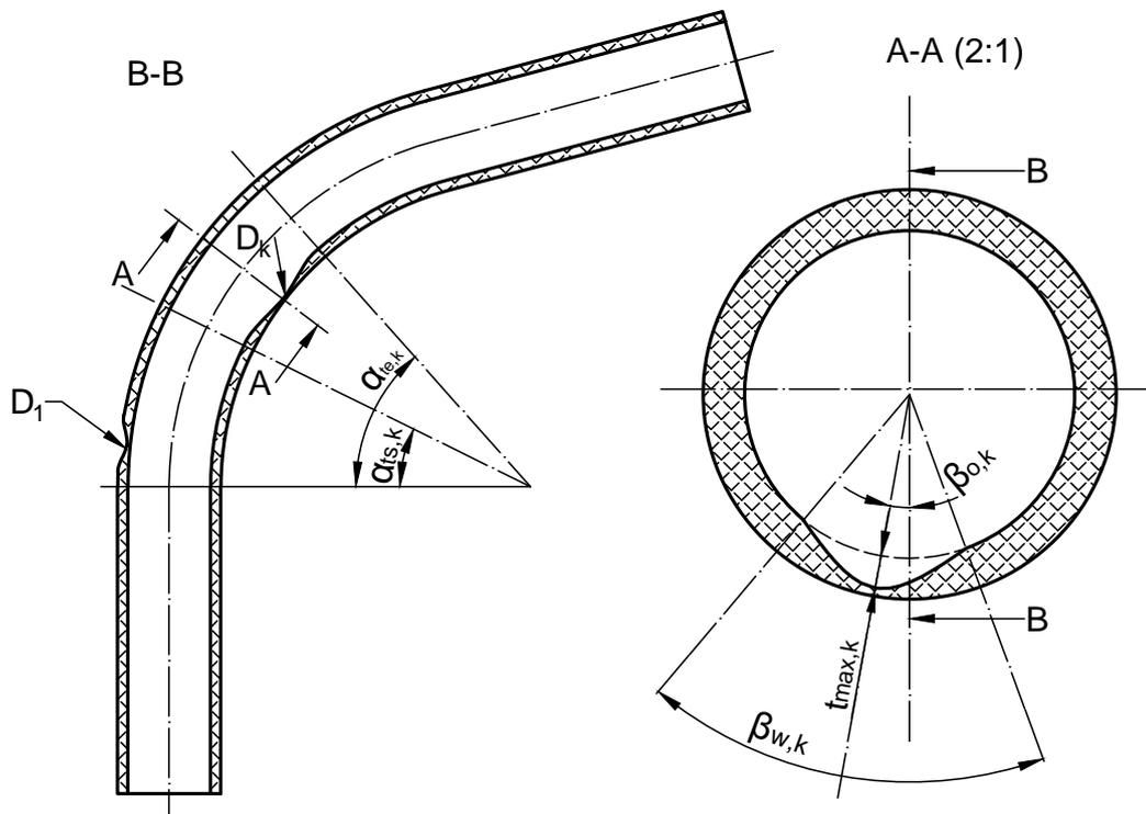
Abbildung 3.6.: Angabe der Wanddickenreduzierung bei den Rohrbogen
