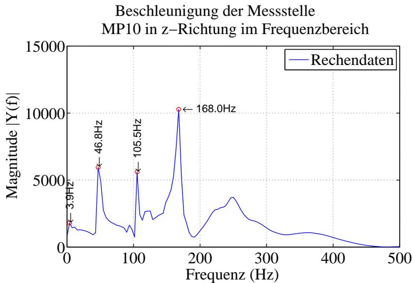
(b) Der Beschleunigungsverlauf der Messstelle MP10 in Z-Richtung im Frequenzbereich aus dem Rechenmodell
