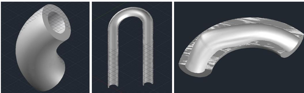
Abbildung 3.2.: Mit PipeGen erstellte Rohrbogen-Modelle
