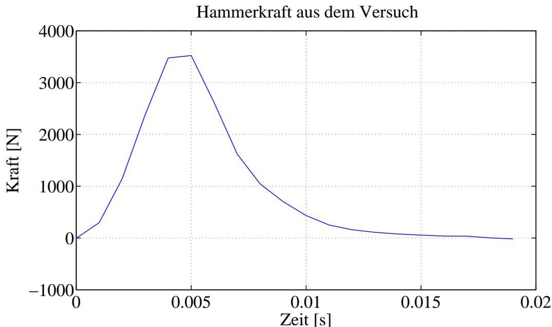
Abbildung 4.18.: Die gemessene Hammerkraft
