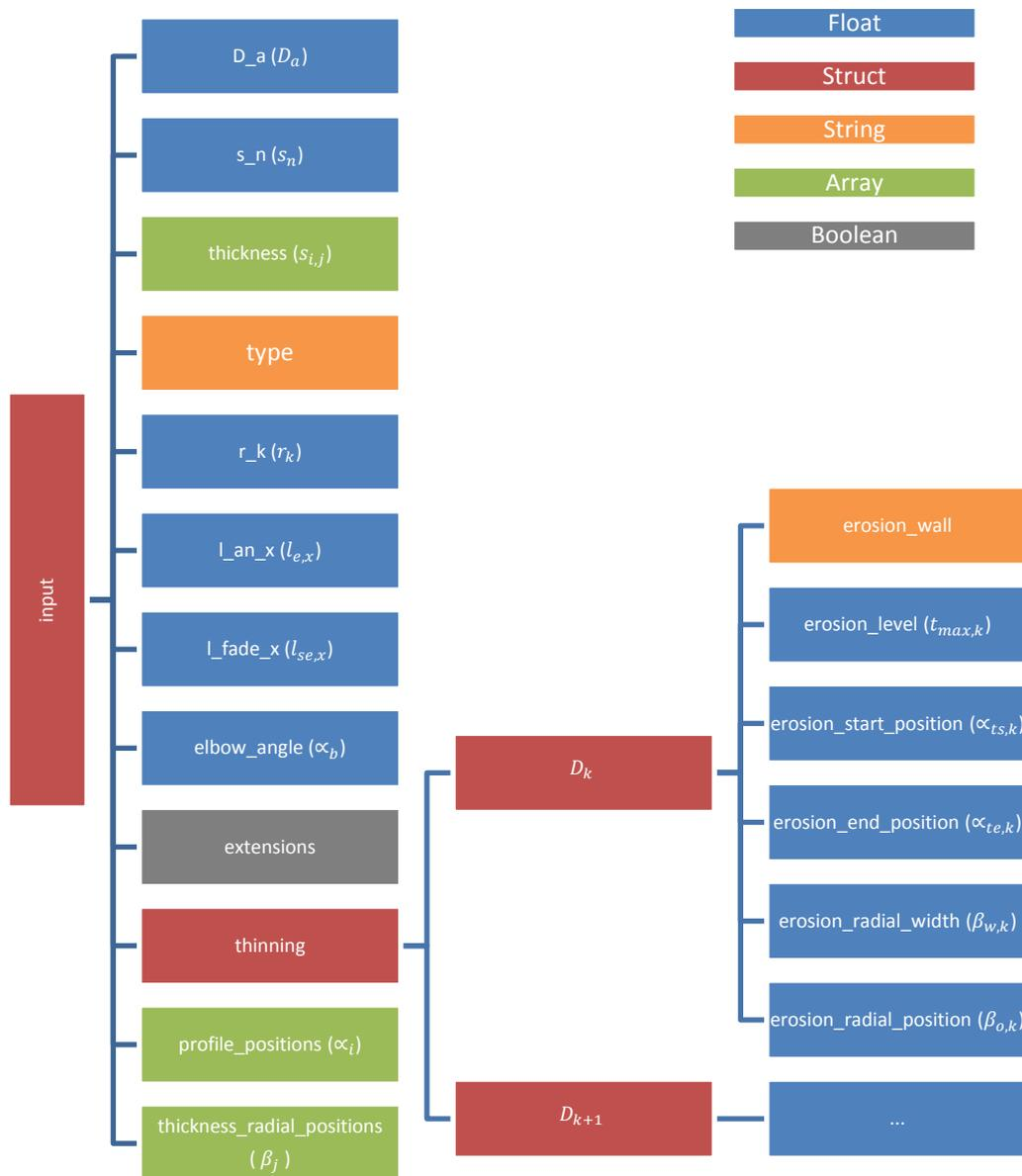
Abbildung 3.3.: Input Struktur für einen Rohrbogen
