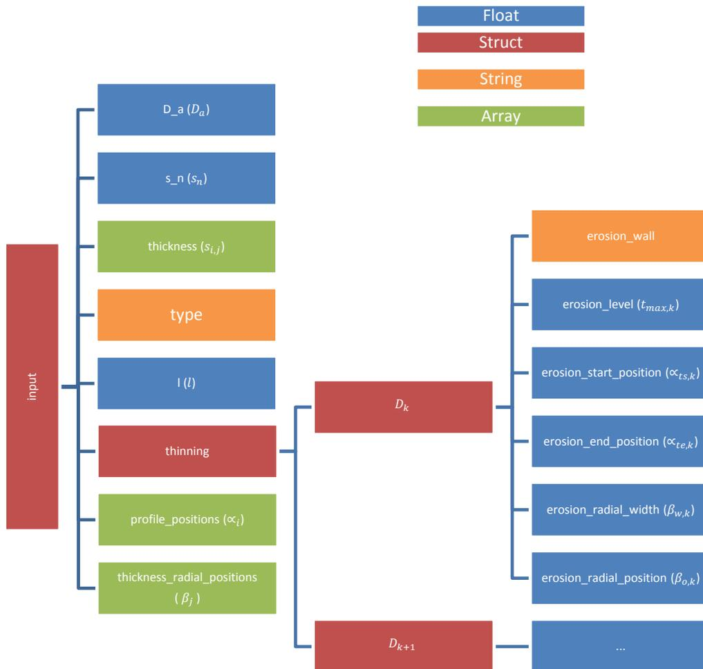
Abbildung 3.8.: Input-Struct für einen Rohrbogen
