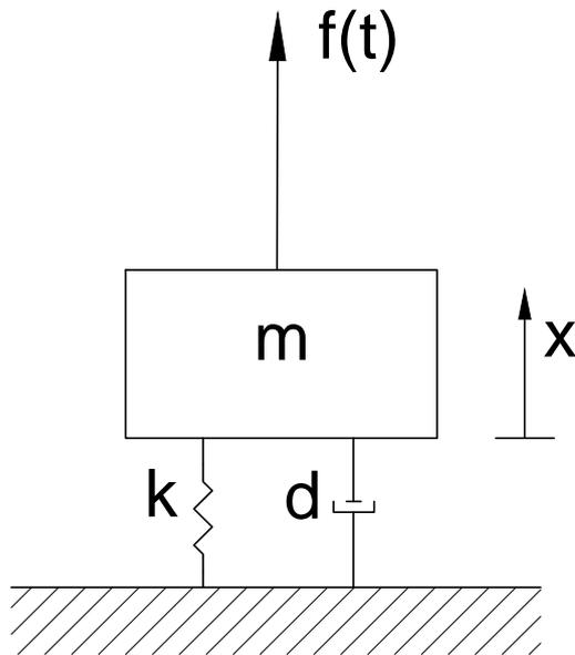
Abbildung 2.1.: Gedämpfter Einmassenschwinger
