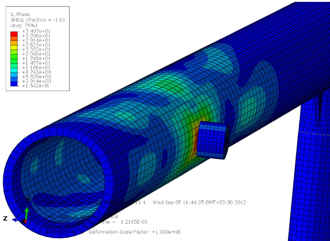
Abbildung 4.19.: Spannungsverteilung auf dem Rohr während dem Stoß
