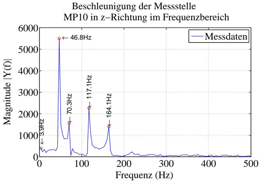
(a) Der Beschleunigungsverlauf der Messstelle MP10 in Z-Richtung im Frequenzbereich aus den Messwerten
